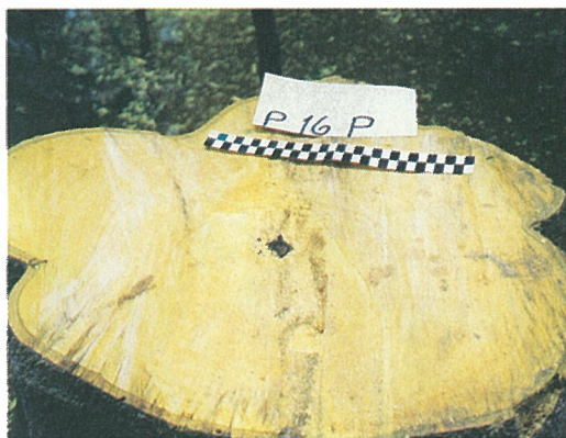
Tronco recién cortado, el color amarillo intenso entre albura y duramen no diferenciado "Moena negra" Diospyros guianensis
