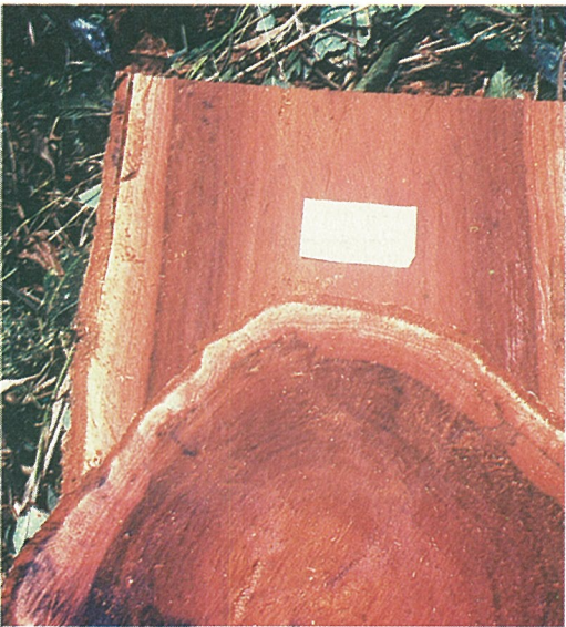
Tronco recién cortado el color bien diferenciado entre albura y duramen "Mascarey" Hyeronima alchorneoides
